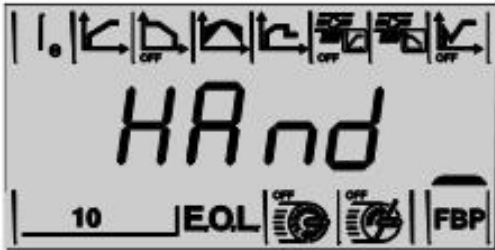
Obr. 7.31: Druh zpětného nastavení po komunikační chybě na síti Fieldbus
