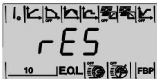
Obr. 7.34: Zpětné nastavení (reset) všech parametrů na standardní uživatelské hodnoty – zobrazení na displeji
