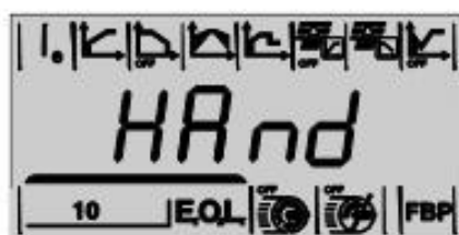
Obr. 7.22: Způsob zpětného nastavení (resetu) po aktivaci elektronické ochrany motoru EOL – zobrazení tohoto parametru na displeji.
