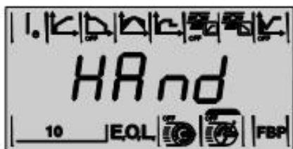
Obr. 7.26: Způsob zpětného nastavení (resetu) aktivované ochranné funkce Locked Rotor Protection (ochrana před zablokováním rotoru). Zobrazení tohoto parametru.
