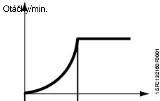
Obr. 7.5: Průběh otáček při rozběhu podle rampy (Start Ramp Time)
